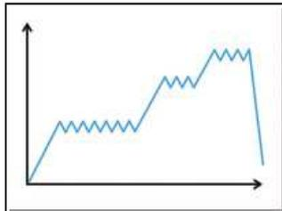
En cas de chute, le déchirement de la sangle de l'absorbeur d'énergie limite la force de choc subie par l'utilisateur. Les longes sont destinées à des utilisateurs dont le poids est compris entre 50 et 130 kg. Le déchirement de la sangle se fait par paliers afin de limiter la décélération subie par les faibles poids.
