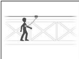
Les longes à simple brin ABSORBICA-I permettent de s'assurer, en particulier sur une ligne de vie horizontale ou une plateforme élévatrice.
