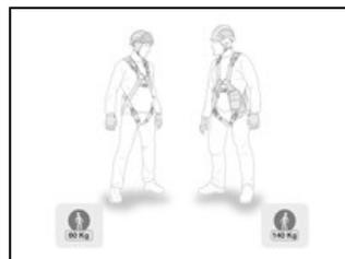
En cas de chute, le déchirement progressif de la sangle de l'absorbeur d'énergie limite la force de choc subie par l'utilisateur. Les longes sont destinées à des utilisateurs dont le poids est compris entre 60 et 140 kg.
