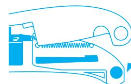
Pour finir, rabattez la **moitié supérieure de la poignée** vers le bas jusqu'à l'enclenchement. Veuillez contrôler la rétraction de la lame !
