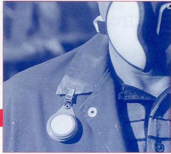
Une méthode simple pour mesurer la concentration moyenne de contaminants présents dans une atmosphère sous la forme de gaz ou de vapeurs, par un prélèvement cumulé sur une période donnée.
